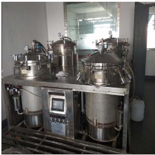
封闭式循环罐
