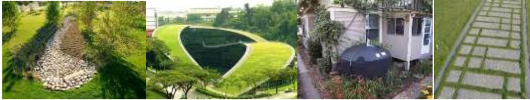
图 5-24 植草沟 图 5-25 绿色屋顶 图 5-26 雨水桶 图 5-27 透水铺装
