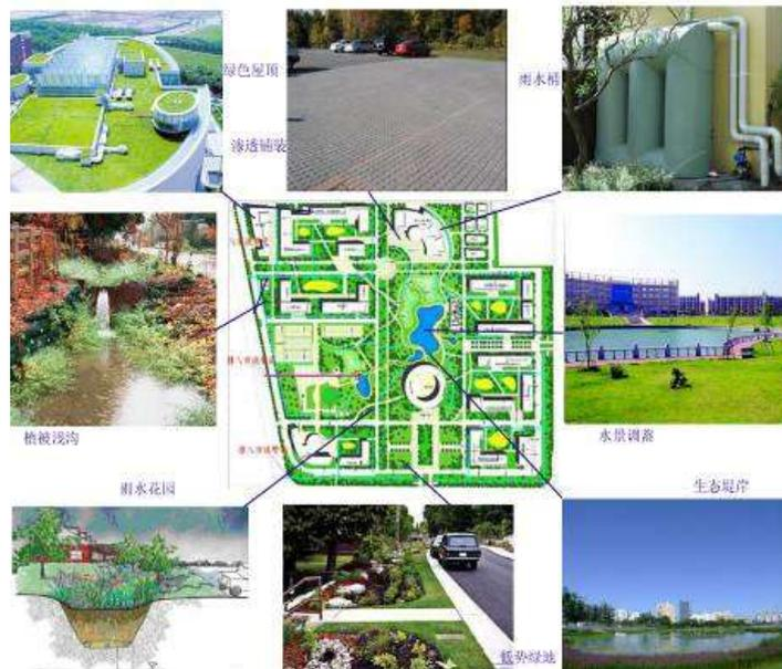
图 5-38 公共管理与公共服务设施用地雨水控制利用平面规划示意
