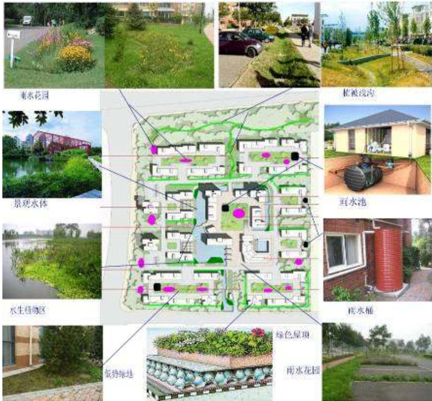
图 5-28 有水景居住用地海绵城市建设示意图
