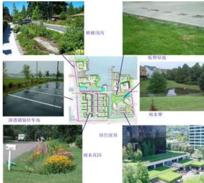
图 5-37 商业设施用地雨水控制利用平面规划示意
